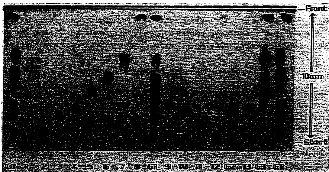
Fig. 2. Dünnschicht-Chromatogramm vom Zuckerm (je 0,5 \mu g) auf einer gepufferten Kieselgur G-Schicht. Die Sichtbarmachung erfolgte mit dem beschriebenen Anisaldehyd–Schwefelsäure-Reagenz. G 1 = Gemisch vom No. 1–8; G 2 = Gemisch vom No. 9–12; G 3 = Gemisch von No. 5–9. In der Tabelle I sind unter dem Nummern 1–13 die verschiedenen Zucker aufgeführt.
